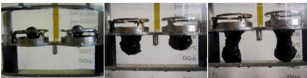
Figura 24 - Verificação da medida do ponto de amolecimento do CAP
