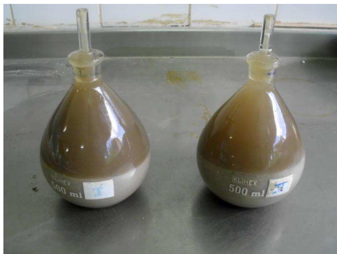
Figura 16 - Picnômetro com amostra submersa em água
