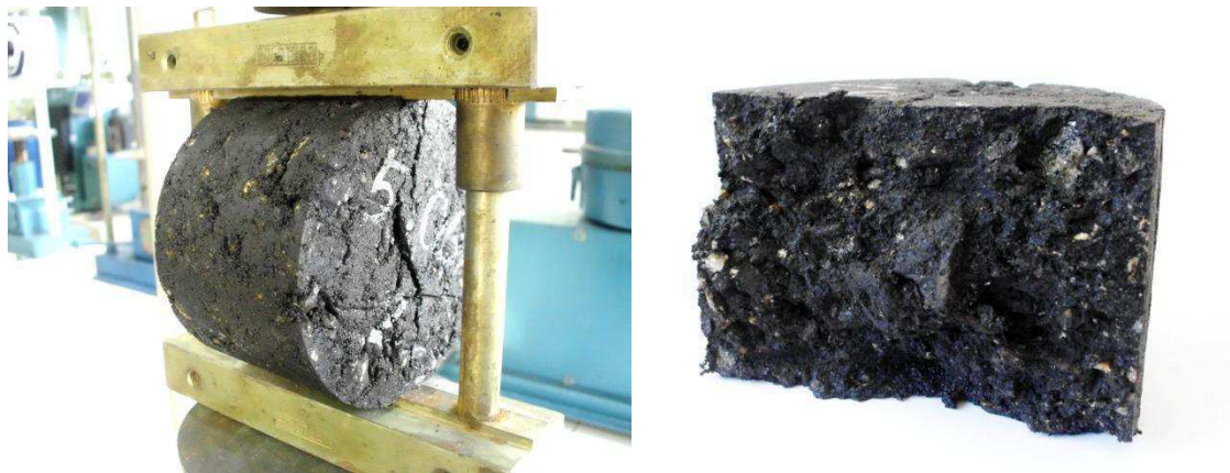
Figura 38 - Ruptura do corpo-de-prova por tração
