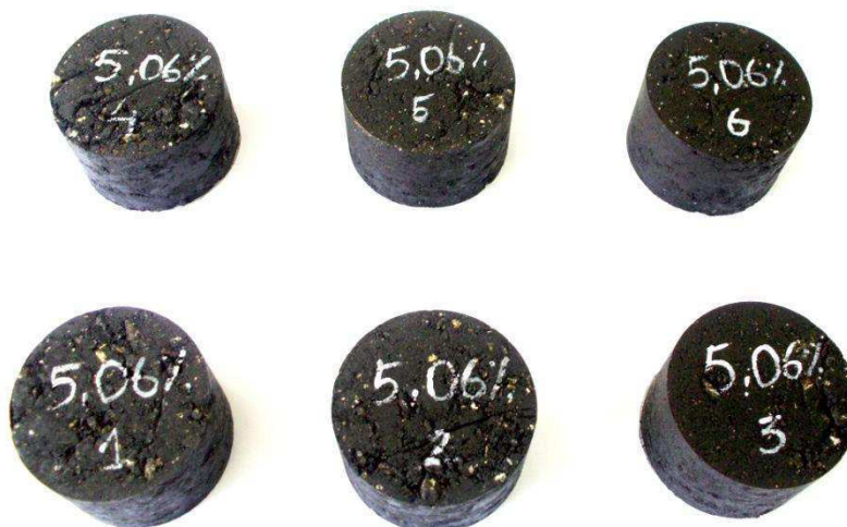
Figura 35 - Corpos de prova moldados no teor de projeto de 5,06% de CAP e 4% de Vv
