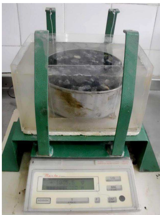
Figura 12 - Verificação da massa submersa da brita 19mm
