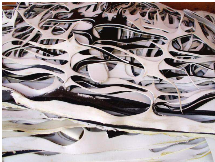
Figura 3 - Resíduo de EVA da indústria calçadista em forma de corte de aparas
