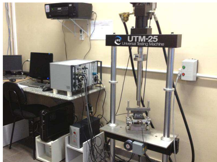
Figura 39 - Prensa UTM-25 utilizada no ensaio de Módulo de Resiliência
