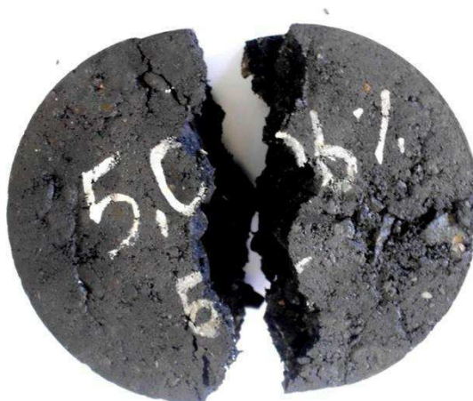
Figura 42 - Rompimento do corpo-de-prova após o condicionamento
