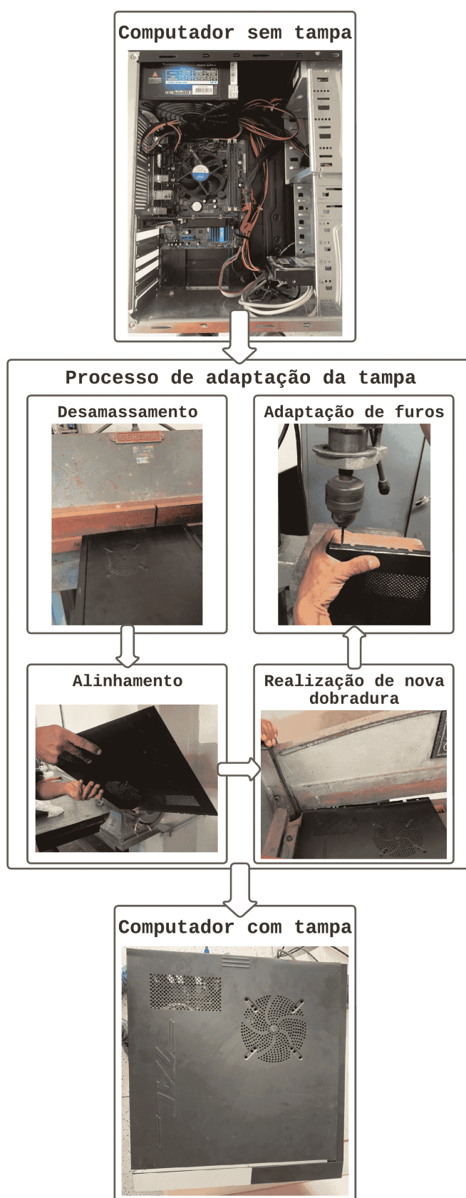
Figura 39 – Diagrama de blocos do processo de remodelagem de uma tampa para computador.
