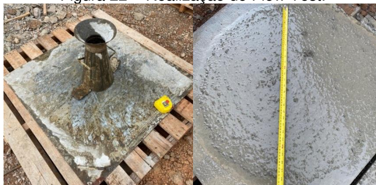
Figura 22 – Realização do Flow Test.
