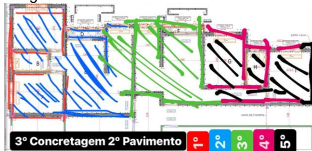
Figura 25 – Rastreabilidade do concreto.
