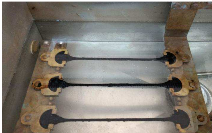
Figura 43 – Amostras submetidas ao ensaio de recuperação elástica no ductilômetro.
