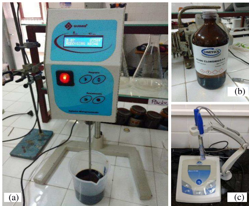
Figura 34 – Agitador e materiais utilizados na correção do pH.
