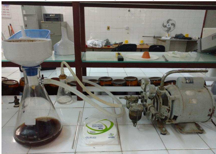
Figura 36 – Instrumentação da filtração à vácuo.
