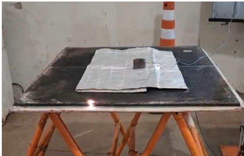
Figura 16 - Ensaio dos tapetes isolados
