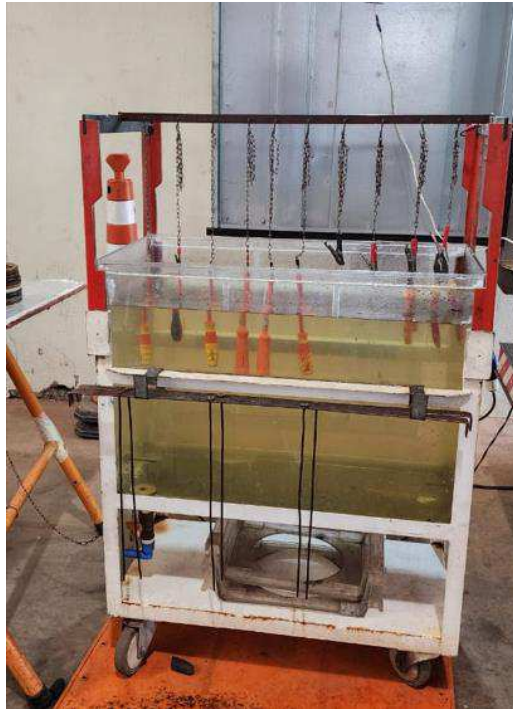
Figura 14 - Ensaio das ferramentas isoladas
