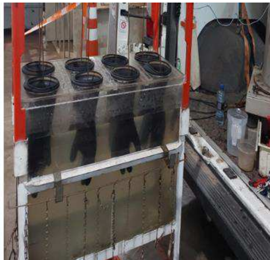
Figura 15 - Ensaio das luvas isoladas
