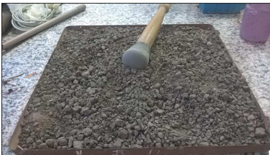
Figura 26 - Preparação de amostras para ensaios de caracterização.
