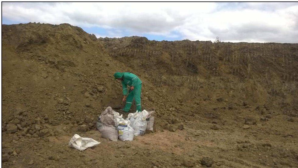
Figura 25 - Coleta do solo para ensaios de caracterização.
