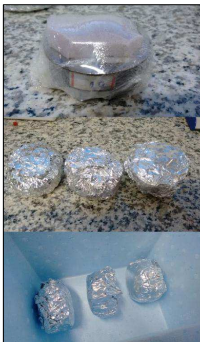
Figura 34 - Amostras envolvidas com filme plástico e acondicionadas.
