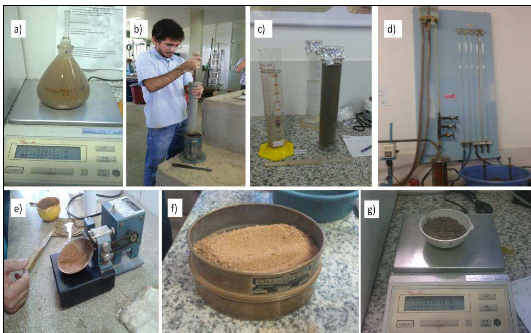
Figura 27 - Caracterização física do solo em laboratório: a) massa específica dos grãos, b) compactação, c) granulometria por sedimentação, d) permeabilidade à água, e) limite de liquidez, f) granulometria por peneiramento, g) pesagem do material.
