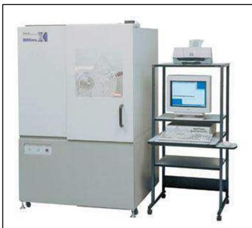
Figura 30 - Equipamento de análise mineralógica por Difração de Raios-X (DRX).
