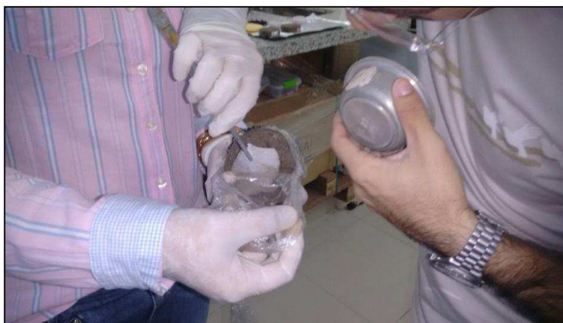
Figura 35 - Retirada do papel filtro das amostras.
