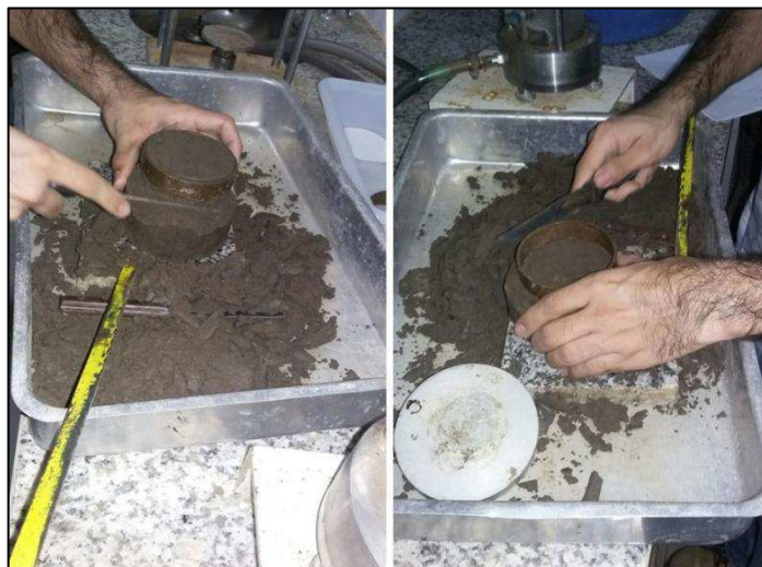
Figura 32 - Moldagem de amostras para ensaio de sucção.
