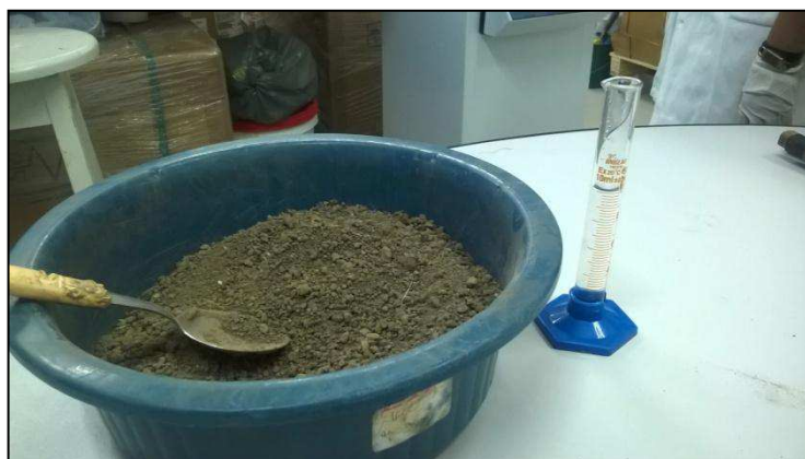
Figura 39 - Solo para calibração dos sensores de umidade.
