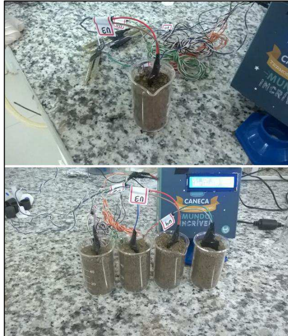
Figura 40 - Procedimento de aferição da umidade do solo.
