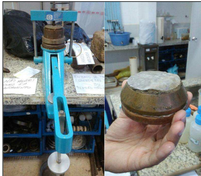
Figura 36 - Ensaio de índice de expansão do solo.
