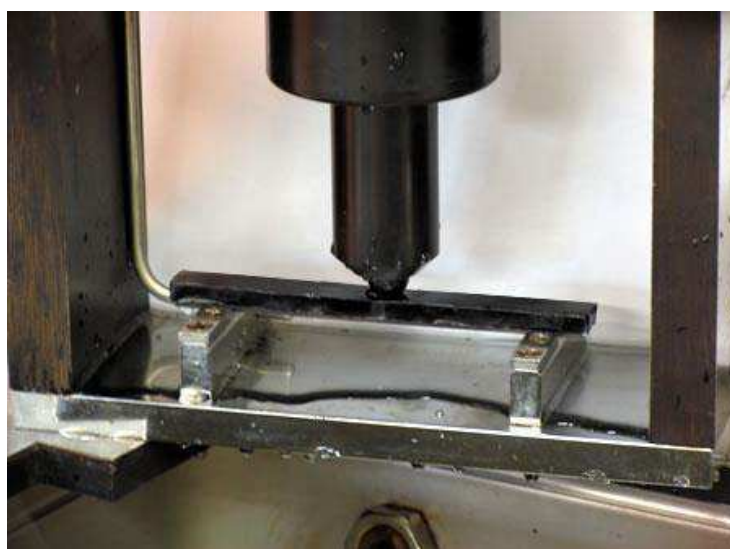
Figura 3 - Execução do ensaio de BBR
