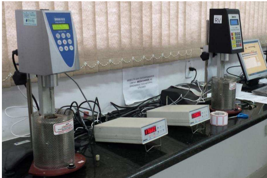
Figura 22 - Viscosímetros utilizados para medição das viscosidades dos ligantes asfálticos
