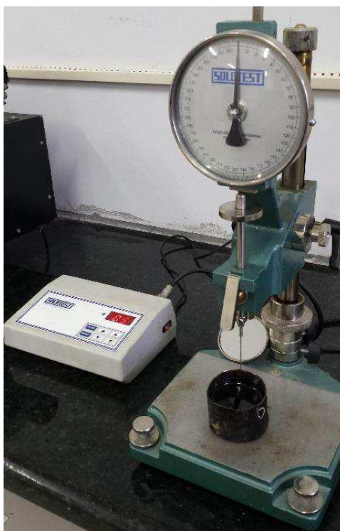
Figura 20 – Ensaio de penetração sendo executado
