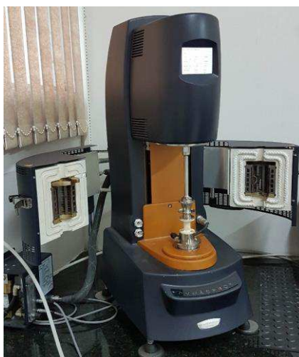
Figura 24- Reômetro de cisalhamento direto (DSR) do Laboratório de Engenharia de Pavimentos LEP/UFCG.
