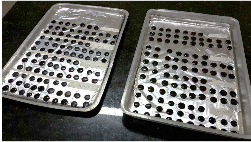
Figura 25 - Amostras de ligantes asfálticos modificadas submetidas a exposição UV
