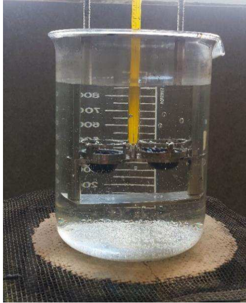
Figura 21 - Execução do ensaio de ponto de amolecimento
