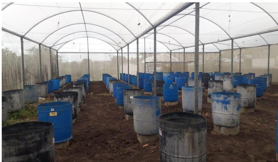
**Figura 4.** Vasos adaptados como lisímetros de drenagem
