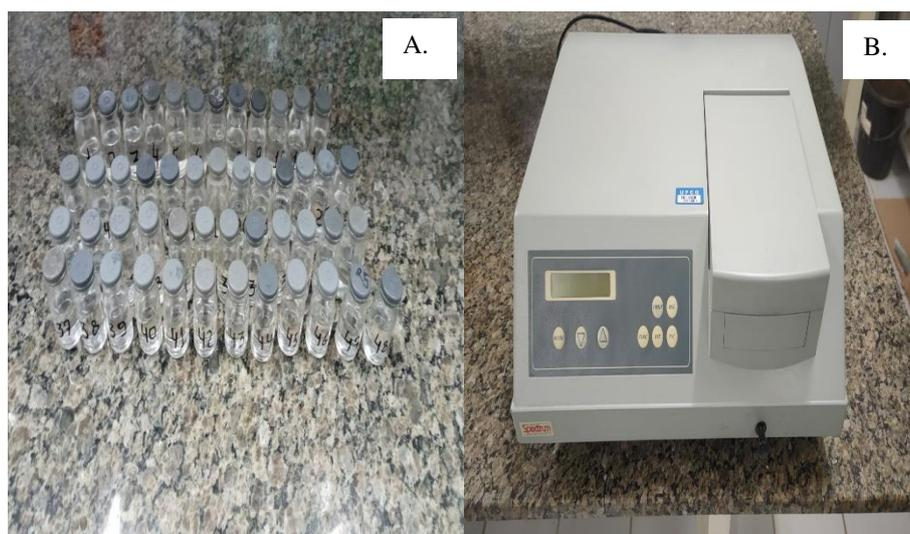
**Figura 12.** Quantificação dos teores de pigmentos fotossintéticos das amostras de folhas de gravioleiras (A) através do equipamento espectrofotômetro (B).
