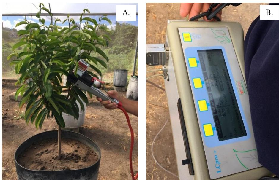
**Figura 10.** Determinação das trocas gasosas de gravioleira (A) utilizando um equipamento portátil de medição de fotossíntese “LCPro+” da ADC Bio Scientific Ltda (B).
