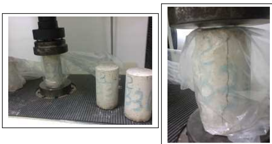
Figura 4- Corpos de prova no ensaio de resistência a compressão
