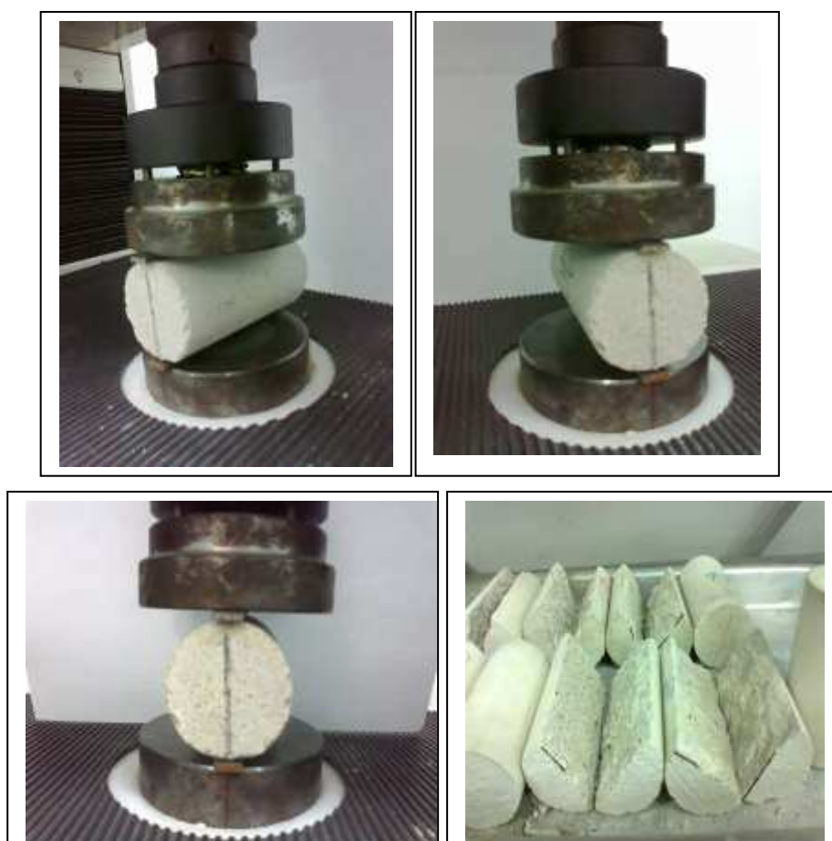
Figura 5 - Corpo de prova no ensaio de resistência a tração por compressão diametral
