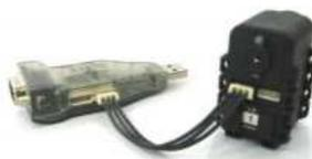
(a) Conexão USB2DYNAMIXEL.
