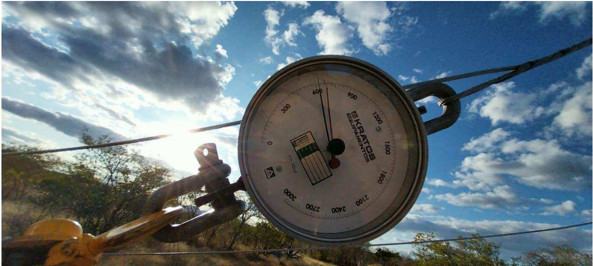
Figura 5.1.4-c Dinamômetro utilizado em atividade de tracionamento de cabos
