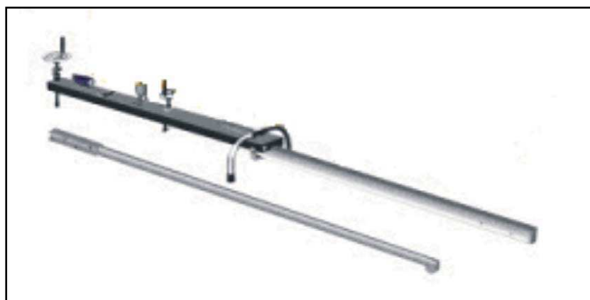
Figura 2.18 - Ilustração da viga Benkelman (www.contenco.com.br)
