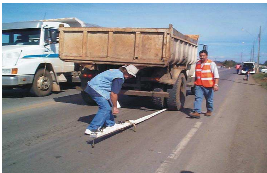
Figura 2.20 - Ilustração do ensaio realizado com a viga Benkelman (Motta et al, 2002).
