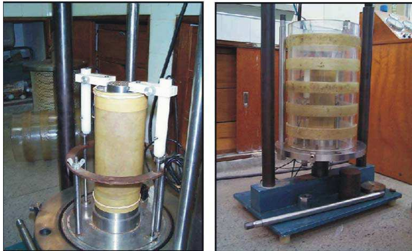
Figura 2.16 – Foto do equipamento triaxial dinâmico da COPPE/UFRJ (Neto, 2004)
