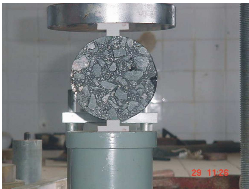
Figura 5.11 – Ensaio de resistência à tração por compressão diametral LEP/UFCG.
