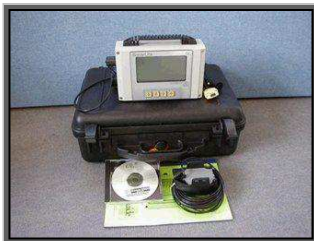
Figura 40. Ecobatímetro modelo OXMEX e transdutor. Fonte: Relatório - Batimetria do Açude Epitácio Pessoa (2004).
