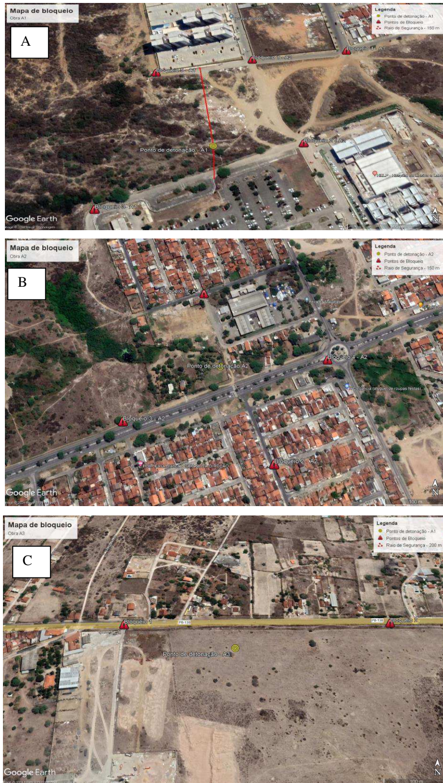
Figura 17: Área de bloqueio no período de detonação de rocha para terraplenagem na Obras A1 (A), Obra A2 (B) e Obra A3 (C).
