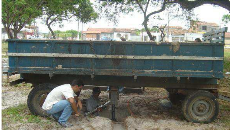
Figura 0.15 - Execução do ensaio de prova de carga estática – posicionamento da viga de referência
