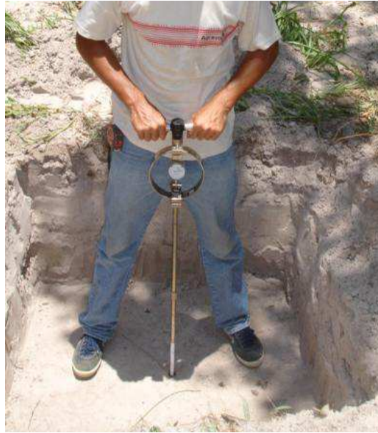
Figura 0.32 - Posicionamento correto do aparelho na cava, posição vertical
