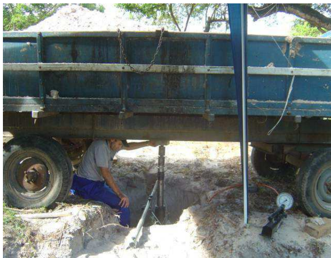
Figura 0.11 - Utilização de eixo de carroceria como reação para o sistema
