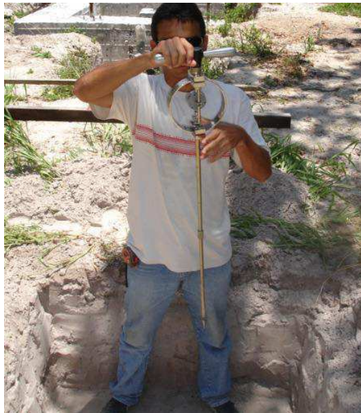
Figura 0.35 - Procedimento de zeragem do relógio comparador para dar prosseguimento ao próximo ensaio
