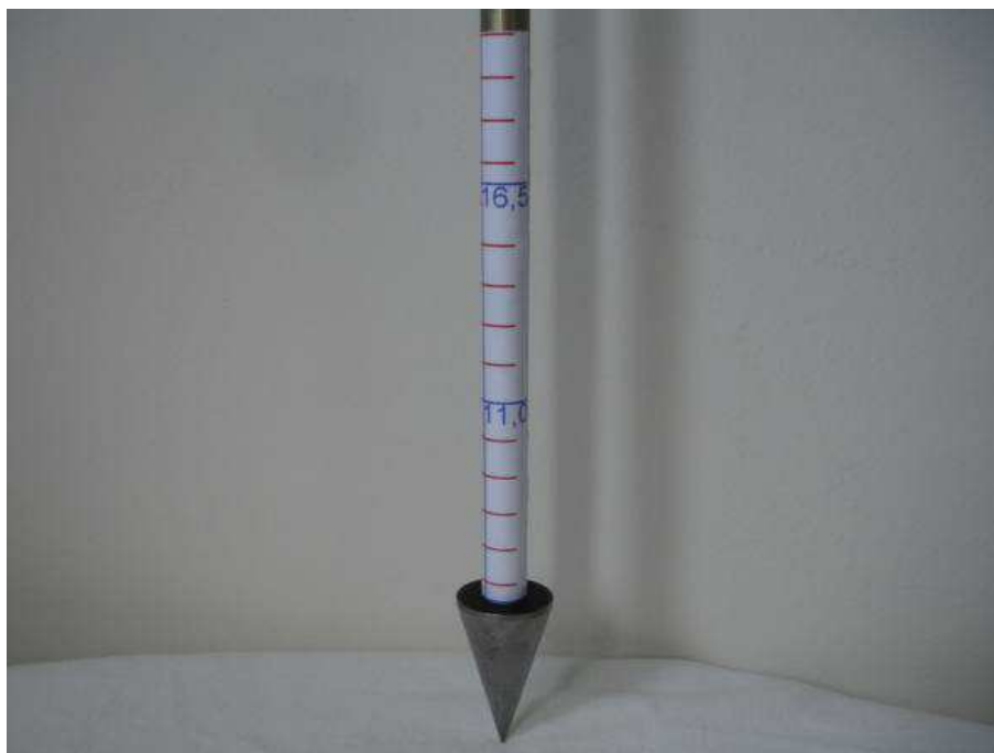
Figura 0.30 – Foto mostrando a régua colocada para melhorar as leituras de penetração
