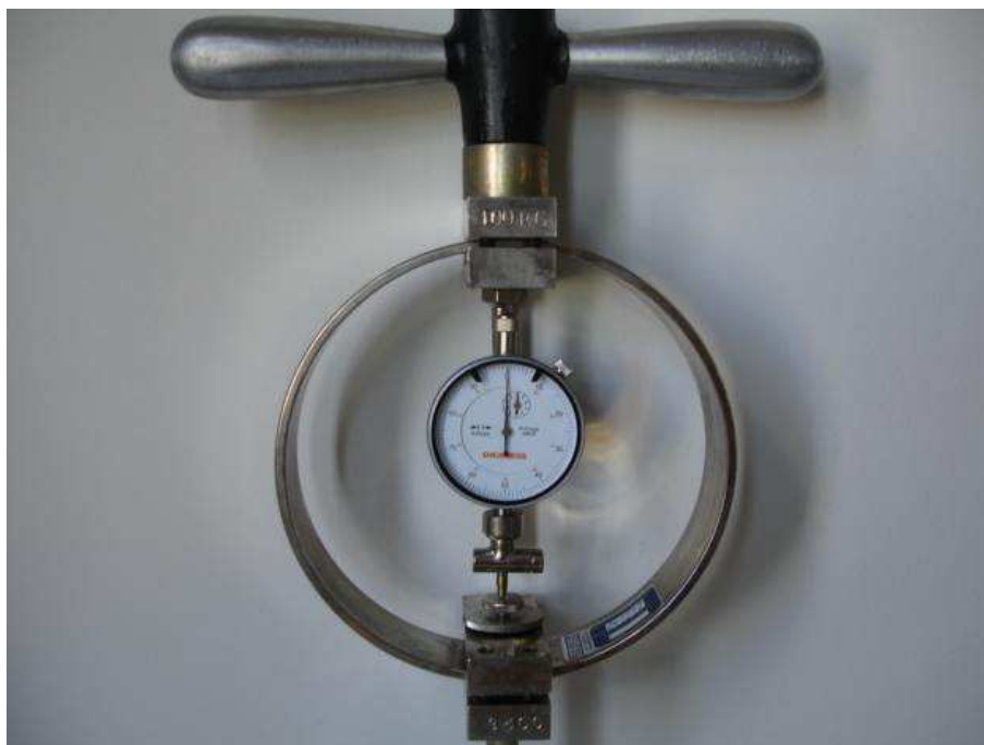
Figura 0.29 – Detalhe do penetrômetro manual utilizado
