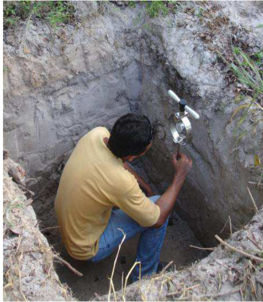
Figura 0.34 - Posicionamento correto do operador para realizar a leitura no anel dinamométrico
