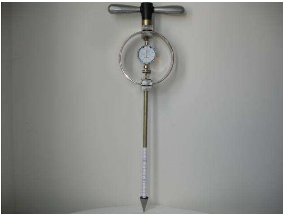
Figura 0.28 – Penetrômetro manual utilizado
