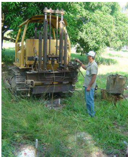
Figura 0.10 – Execução dos ensaios de CPT (com cone tipo Holandês) – penetração
