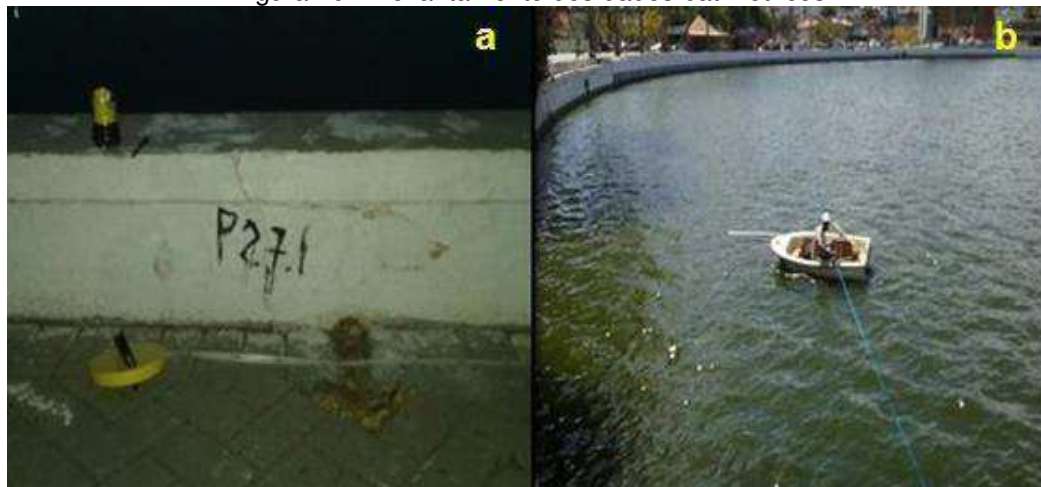
Figura 20 – Levantamento dos dados batimétricos
