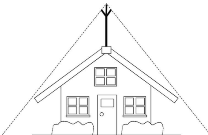
Figura 8 – Ilustração da área de proteção de um captor Franklin.
