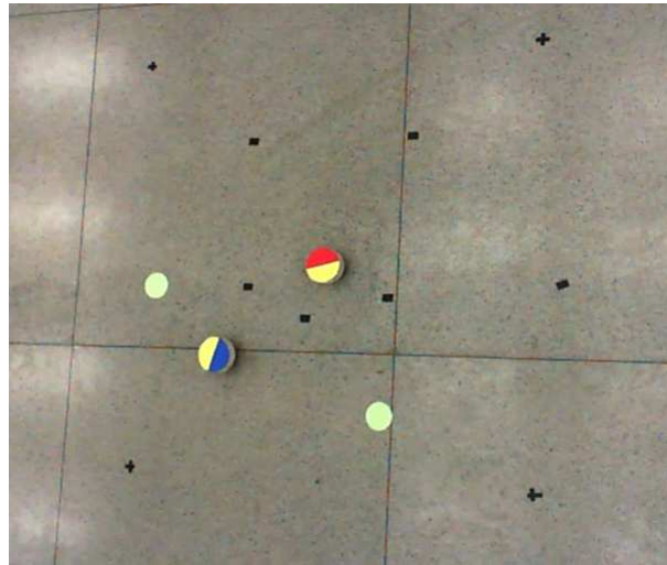
Figura 6.27: Cena da configuração experimental obtida com a câmera. Em verde, tem-se os obstáculos, os símbolos de '+' representam os limites da área de interesse e os pontos pretos em menor proporção a posição dos nós estáticos definidos manualmente.
