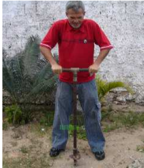
Figura 0.9 - Execução da perfuração a trado para retirada das amostras
