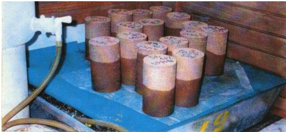
FIGURA 4.15 - Ensaio de durabilidade por absorção capilar de água.
