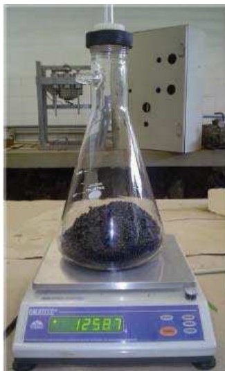
Figura 5.10: Determinação da massa seca da amostra para o ensaio de DMM
