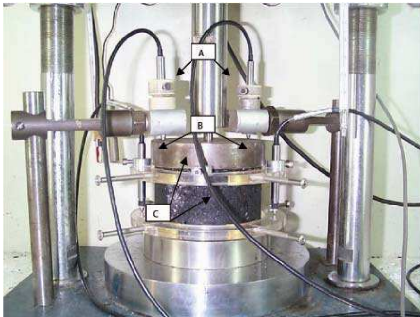
Figura 6.4: Tipos de determinação do deslocamento permanente feitas simultaneamente nos corpos de prova das misturas asfálticas estudadas. A) Medição feita no topo do corpo de prova. B) Medição feita no centro do corpo de prova. C) Alças de sustentação
