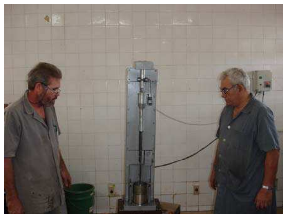
(d) Compactação do corpo de prova.
