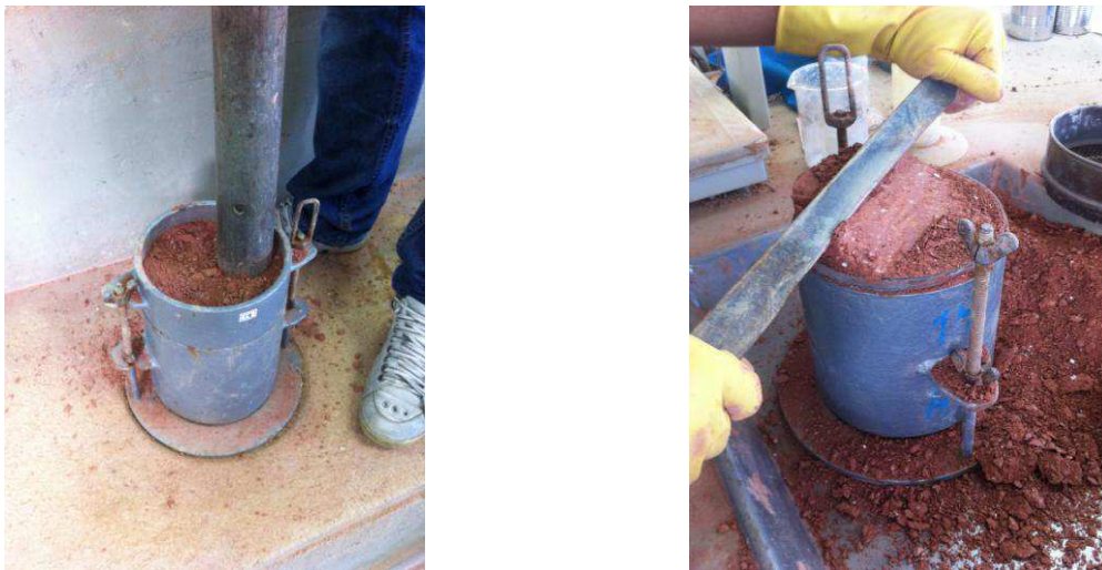
Figura 3.13 – Execução do ensaio de compactação
