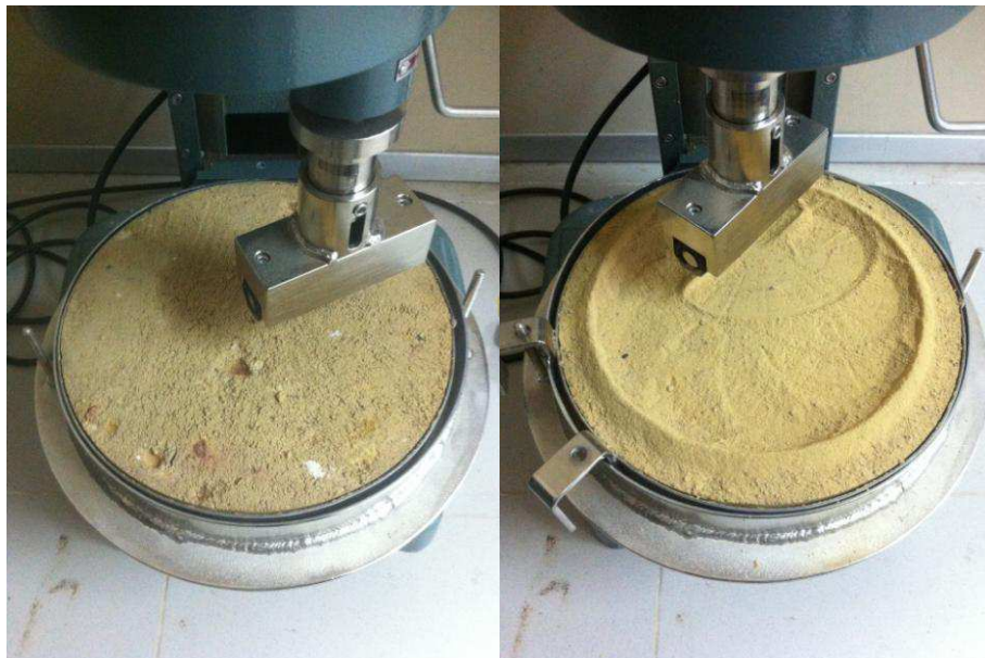
Figura 3.26 – Execução do ensaio de WTAT
