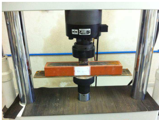
Figura 3.21 – Compactação do corpo de prova de LWT
