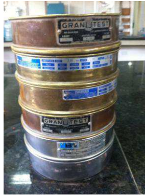
Figura 3.3 – Execução do ensaio de análise granulométrica
