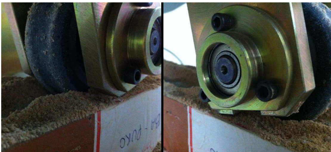
Figura 3.22- Critério de parada utilizado no ensaio de LWT
