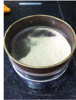
Figura 3.3 – Execução do ensaio de análise granulométrica
