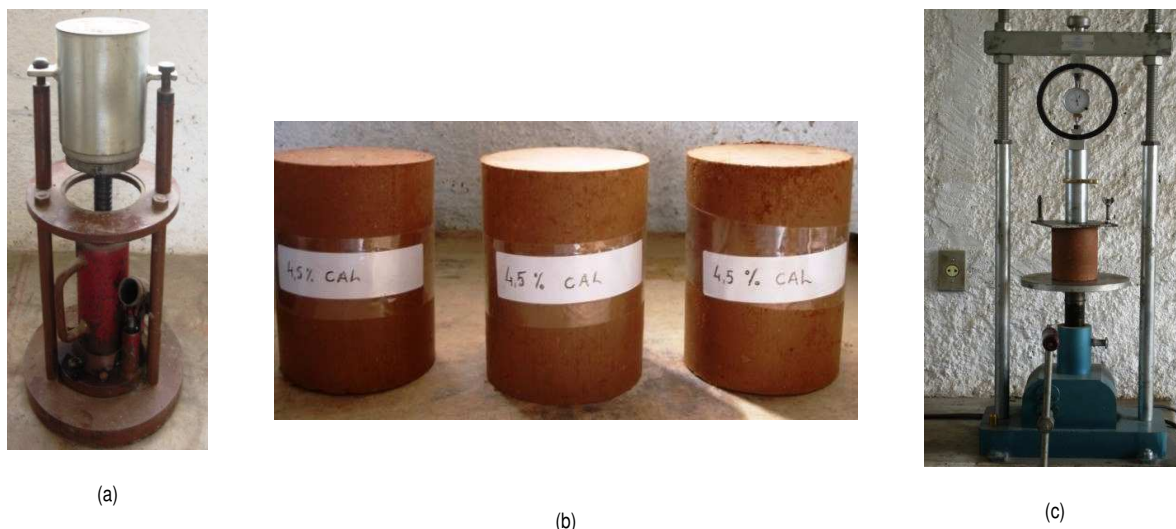
Figura 3.9 – Equipamentos utilizados para a realização dos ensaios de compressão simples
