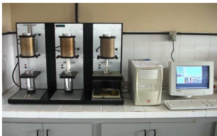
Figura 3.3 - Equipamentos utilizados para realização do ensaio de difração a laser
