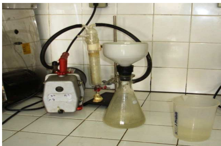
Figura 3.10 – Equipamentos utilizados para obtenção dos extratos lixiviado e solubilizado dos materiais utilizados na pesquisa
