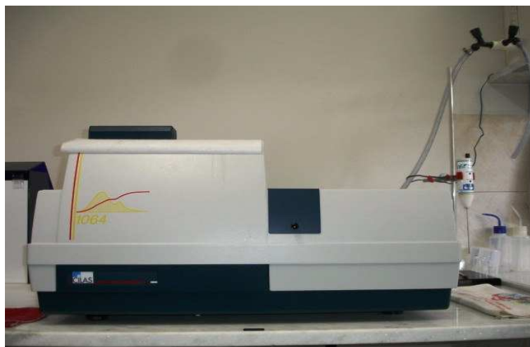
Figura 3.3 - Equipamentos utilizados para realização do ensaio de difração a laser
