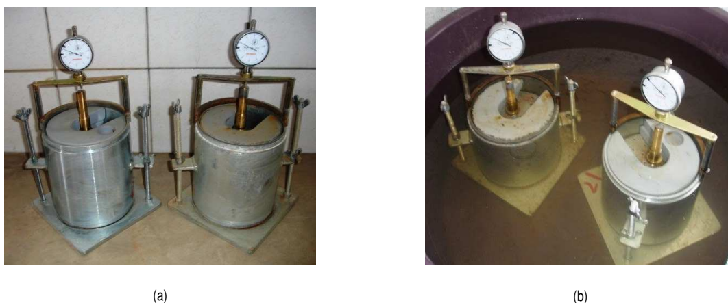
Figura 3.8 - Equipamentos utilizados para realização dos ensaios de expansão
