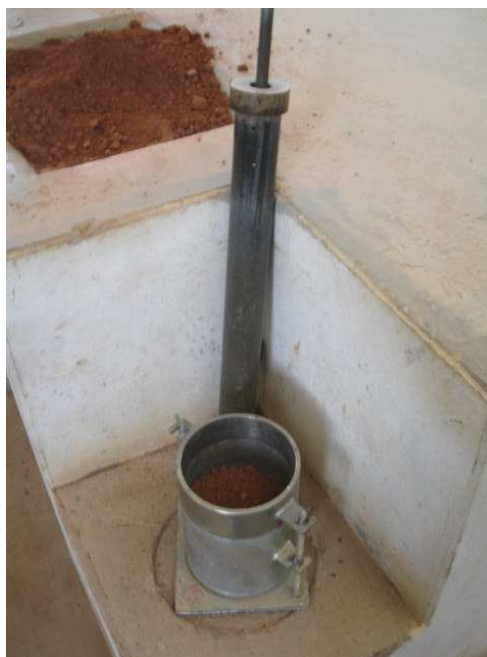
Figura 3.6 –Equipamento utilizado para realização dos ensaios de compactação
