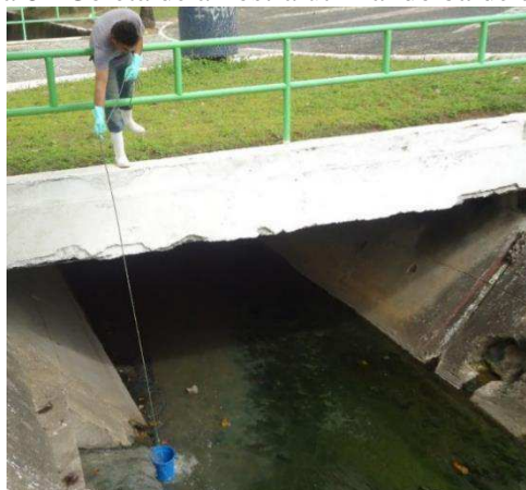
Figura 8 - Coleta de amostra utilizando balde e corda
