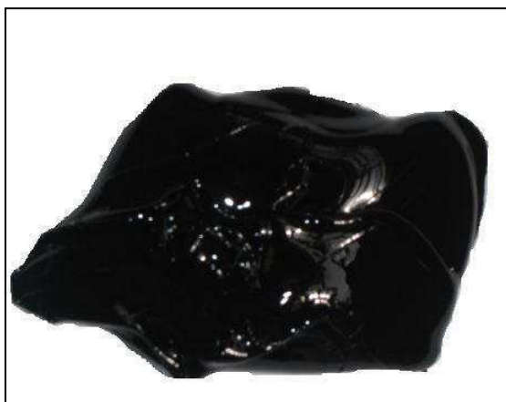
Figura 19– Cimento asfáltico de petróleo utilizado na pesquisa Fonte: Pesquisa direta, 2008
