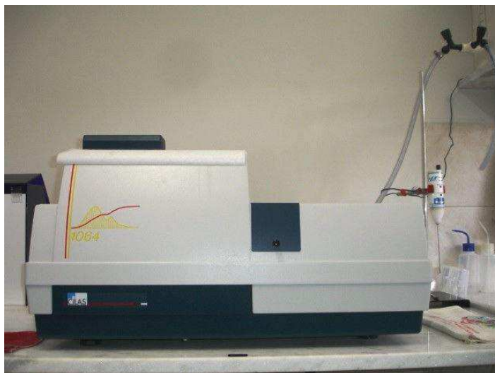
Figura 20 - Equipamento utilizado para realização do ensaio de difração a laser Fonte: Pesquisa direta, 2008
