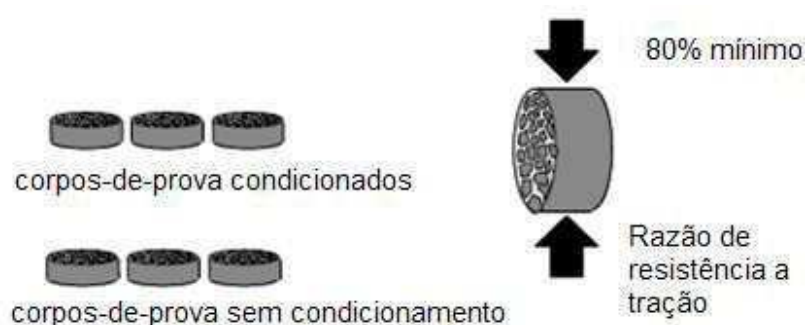
Figura 8- Esquema do ensaio de lottman
