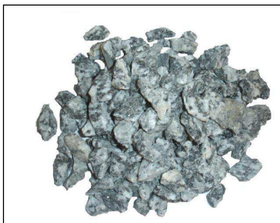
Figura 13 – Agregado do tipo granítico – Brita 19 ou \frac{3}{4} " Fonte: Pesquisa direta, 2008
