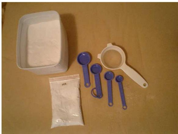
Figura 5. PEUAPM em pó, hidroxiapatita preparada em laboratório e ferramentas de medição de volume utilizadas.
