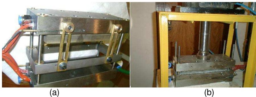
**Figura 8.** Sistema de produção; (a) placas de aquecimento montada com componentes (b) sistema montado no conjunto e em produção.
