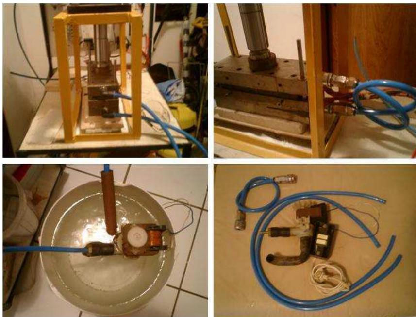
**Figura 9.** Sentido horário: visão frontal do molde, visão traseira do molde com mangueiras do circuito de resfriamento conectadas, componentes do sistema hidráulico e bomba d'água acionada sobre o reservatório.
