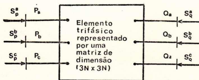
Fig. 3.2 Sentido das injeções do fluxo de potência em cada barramento.
