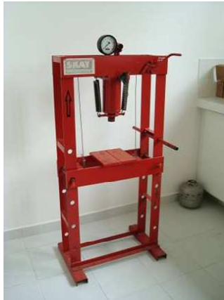
Figura 16- Prensa manual para as vagens de algaroba
