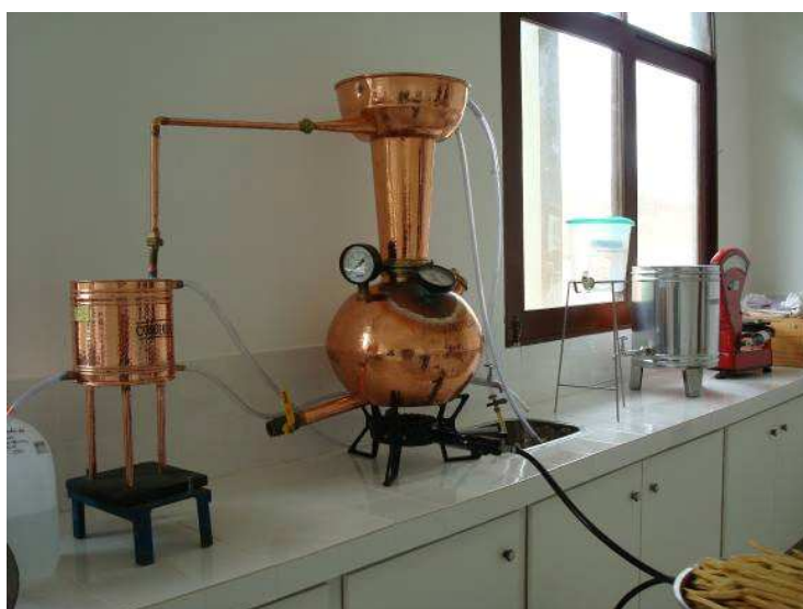
Figura 18-Alambique de cobre usado para destilar a aguardente
