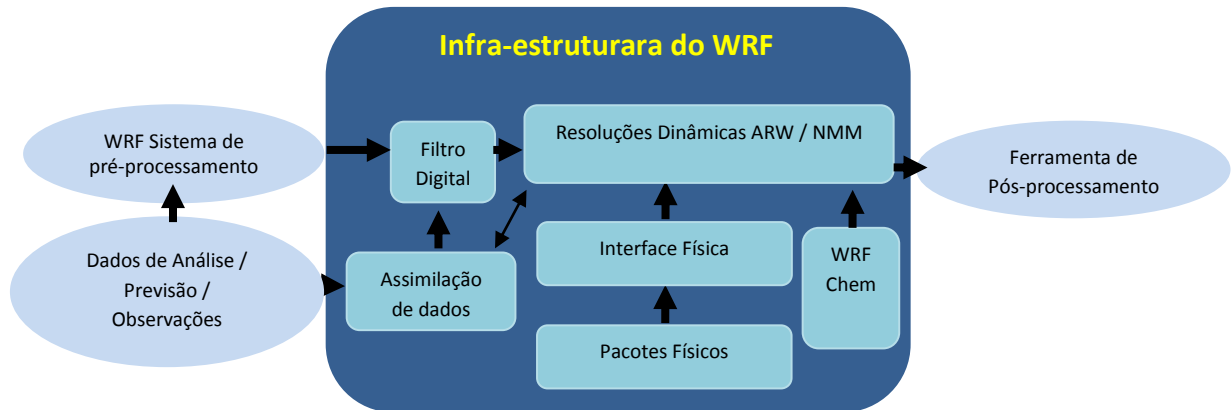
Figura 1 – Diagrama dos componentes do sistema de modelagem WRF-ARW. Fonte: NCAR/UCAR 2011.
