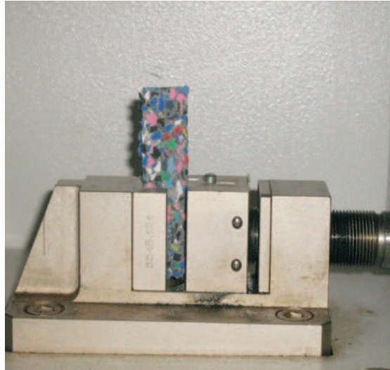
FIGURA 3.10 Detalhe do encaixe do corpo de prova
