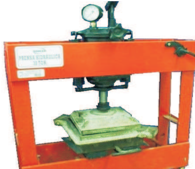
FIGURA 3.4 Prensa e molde metálico usados para produção dos compósitos prismáticos.
