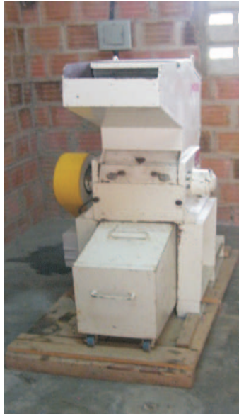
FIGURA 3.2 Moinho de facas rotativas utilizado no beneficiamento do resíduo de SBR.
