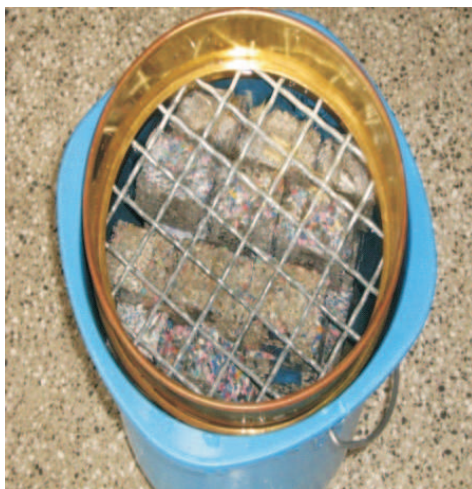
FIGURA 3.8 Detalhes do ensaio de absorção: material imerso
