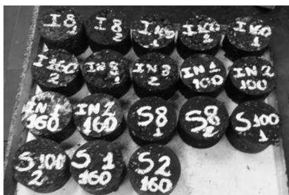
Figura 33 - Corpos de prova no teor estimado de 5% de ligante CAP 50/70 puro
