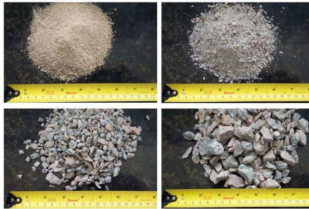
Figura 16 - Agregados: areia, pó de pedra, brita 12.5mm e brita 19mm.
