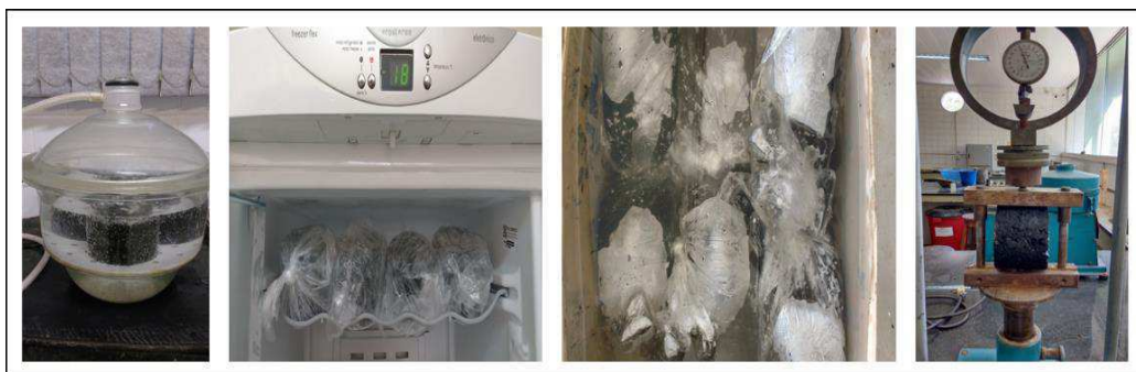
Figura 38: Procedimentos do ensaio de Lottman modificado
