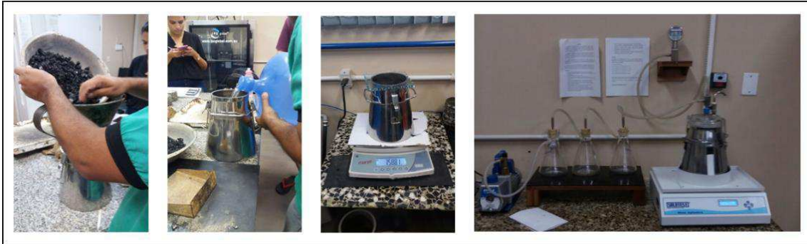
Figura 32 - Procedimento do ensaio para determinação da Gmm
