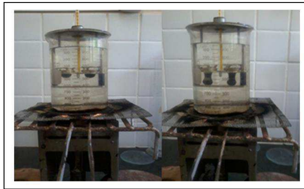
Figura 24 - Realização do ensaio de ponto de amolecimento
