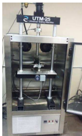
Figura 37 - Prensa UTM-25 utilizada para o ensaio de Módulo de Resiliência
