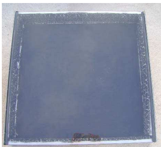
Figura 3.1 – Secador solar para uso diurno
