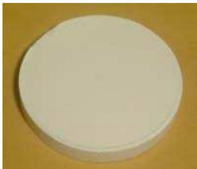
**Figura 18.** Suporte cerâmico sinterizado a 1400°C.
