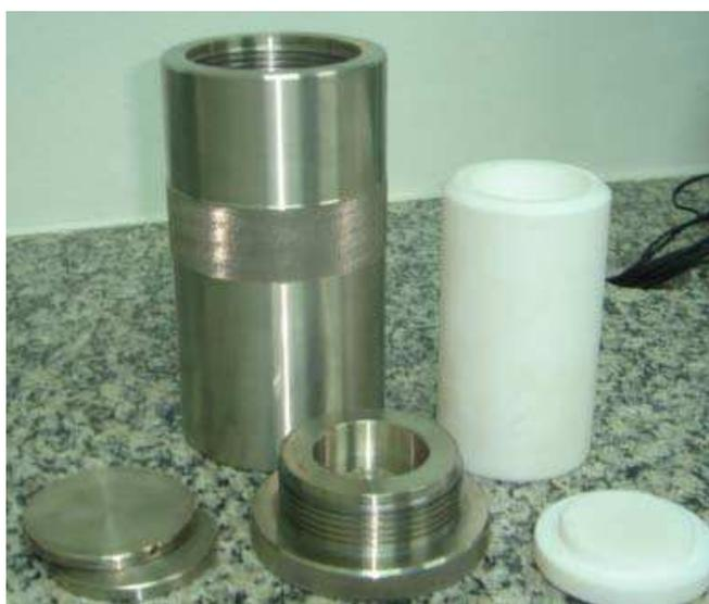
**Figura 16.** Sistema utilizado na síntese da zeólita.
