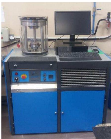
Cada carregamento tem uma duração de 0,10 segundo e intervalos entre as aplicações de carga de 0,90 segundo, tendo como critério de parada ou o alcance de 10.000 ciclos ou uma deformação de 50.000 *microstrains*. Atingindo umas das duas deformações, o ensaio é encerrado (Figura 65).
