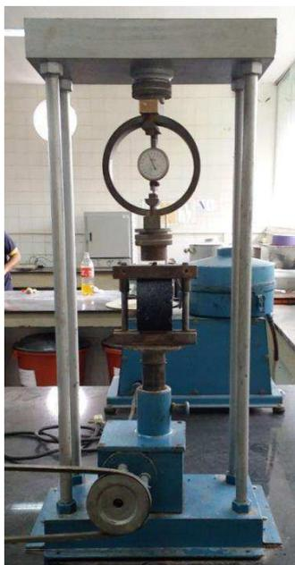
**Figura 57: Realização do ensaio de RT em corpos de prova com teores de Cera de Carnaúba**
