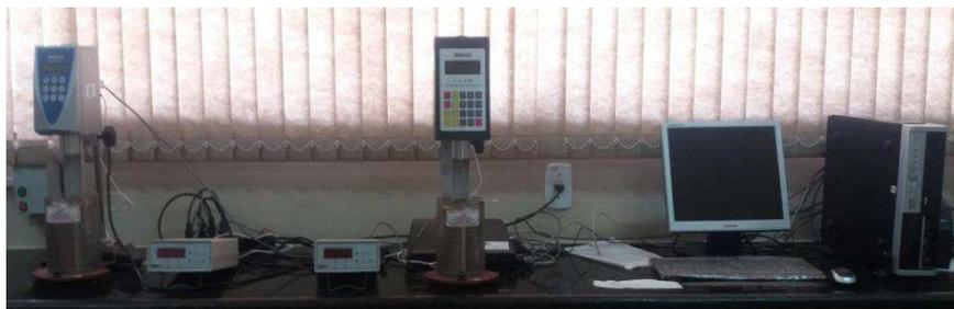
O ensaio foi realizado seguindo a norma NBR 15184/2007. O mesmo consiste em determinar a viscosidade medida através do torque necessário para a rotação de uma haste de prova (spindle) imersa em uma amostra de ligante, considerando as temperaturas de 130, 150 e 177°C e as velocidades de 20,50 e 10rpm.
