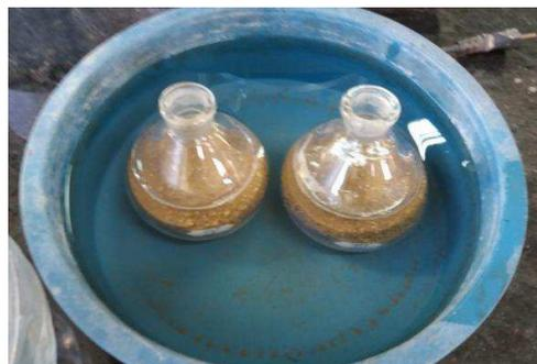
**Figura 31 – (a) Conjunto Picnômetro, água e amostra. (b) Conjunto sendo pesado**
