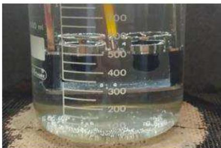
O ensaio finalizou no momento em que as esferas deslocaram-se para baixo e tocaram a placa de fundo (Figura 39). O ponto de amolecimento refere à média das duas temperaturas determinadas.
