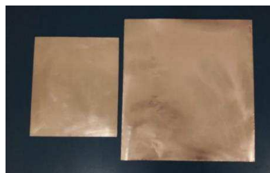
Figura 4.3 – Placas de circuito impresso utilizadas para a confecção dos sensores. Fibra de vidro à esquerda e poliamida à direita.
