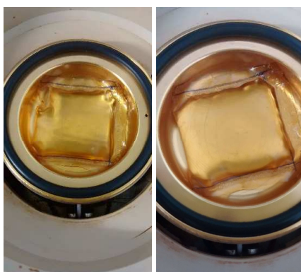
Figura 9 - Teste da embalagem no PetroOXY (Condição: 24h, 50°C e 700kPa)
