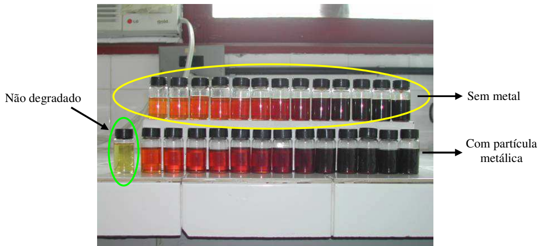
Figura 4.10. Visão das amostras degradadas em função do tempo/temperatura de exposição térmica a 210°C.
