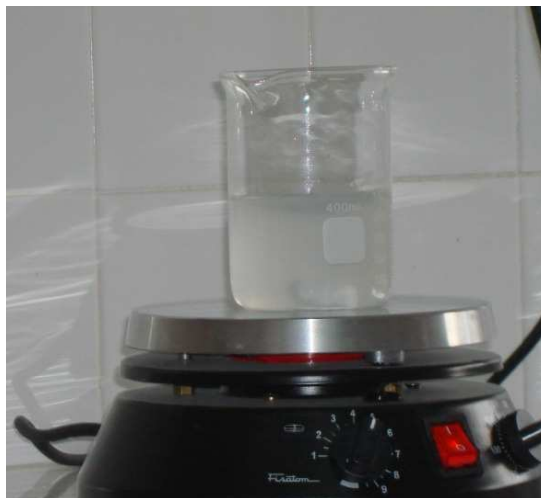
Figura 4.3 - Mistura dos precursores para síntese das matrizes vítreas, sob aquecimento e agitação.
