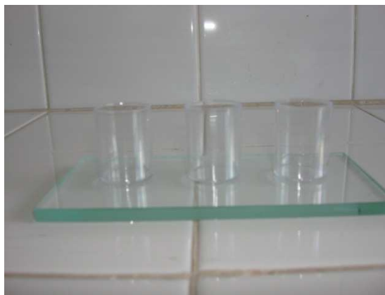
Figura 4.2 - Moldes cilíndricos sobre placas de vidro. Fonte: Pesquisa direta (2009).
