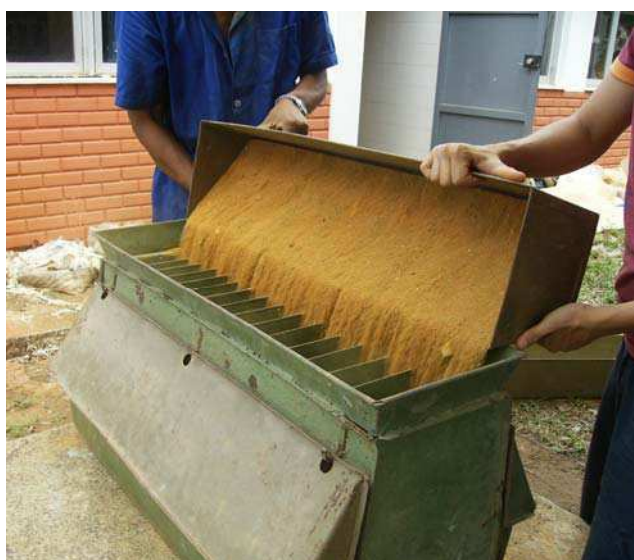
Figura 3. 8 –Procedimento inicial de repartição de amostras com repartidor de 2".
