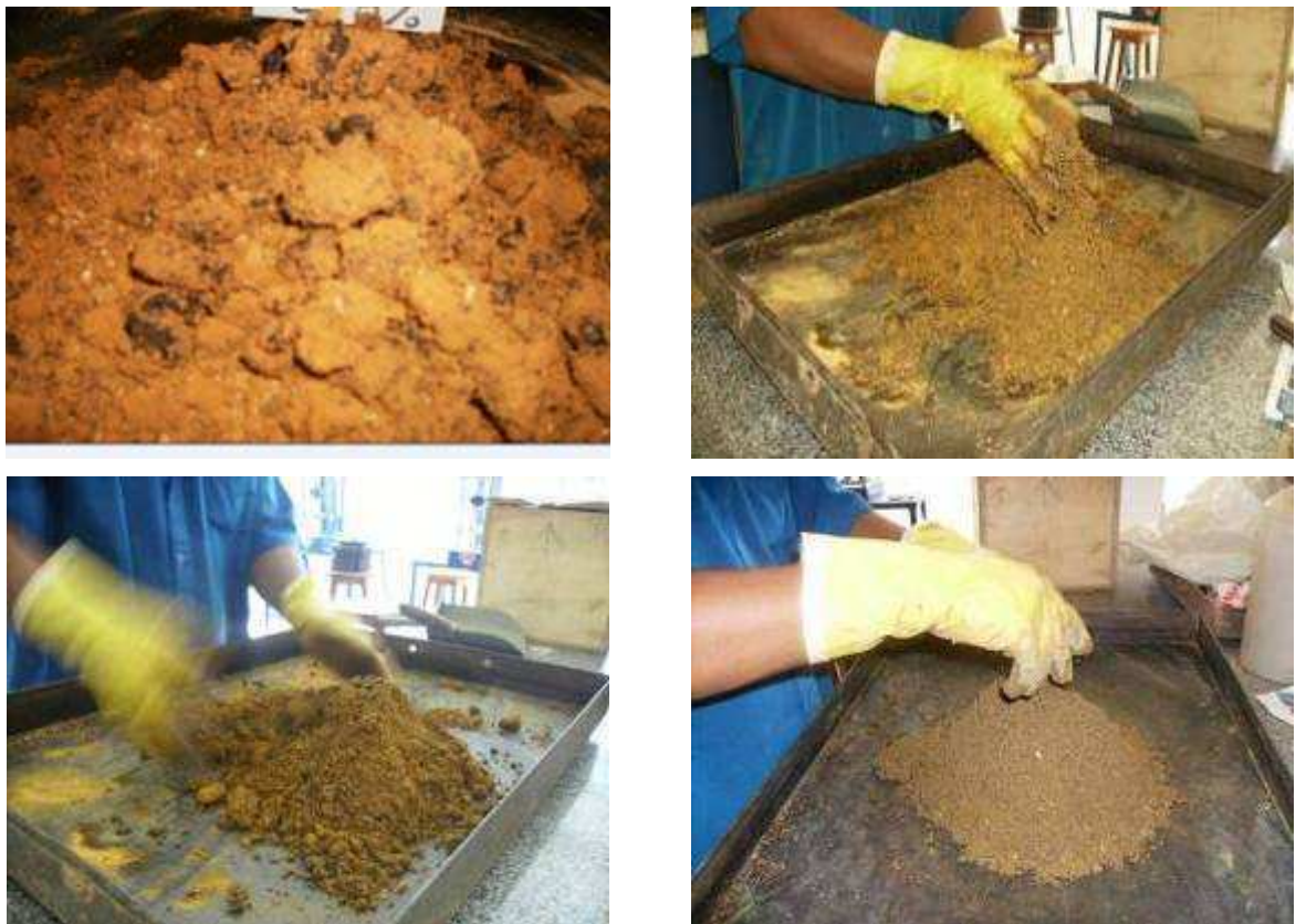
Figura 3. 15 – Fases de homogeneização manual da mistura.
