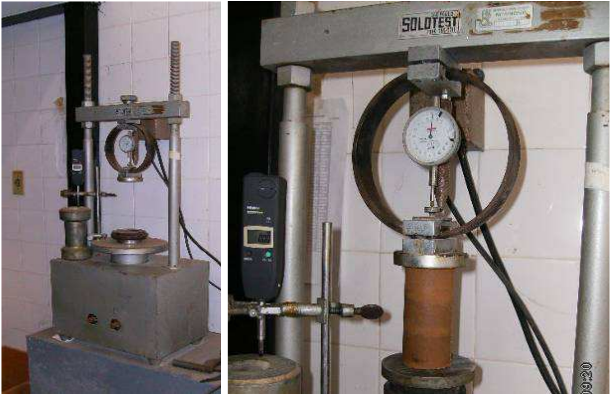
Figura 3. 22 – Prensa de Compressão Simples utilizada no rompimento dos CPs de RCS.
