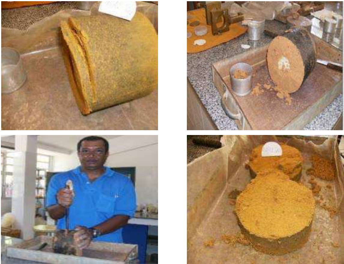
Figura 3. 27 – Etapas envolvendo a obtenção do teor de umidade dos CPs durante ensaios de ISC.
