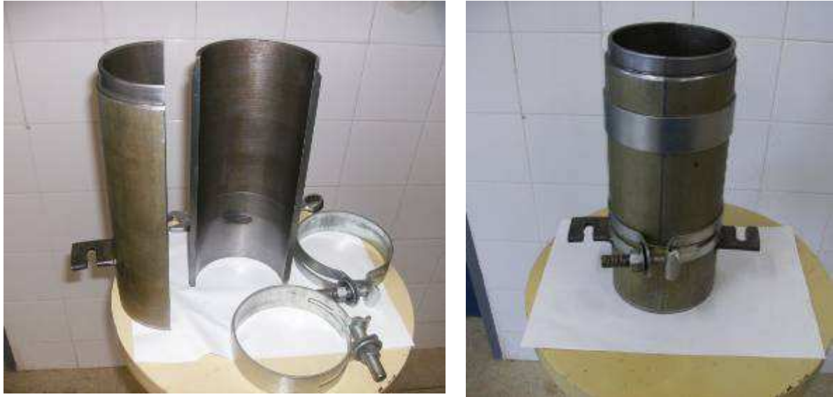
Figura 3. 30 – Cilindro bipartido utilizado na moldagem dos CPs para ensaios de MR.
