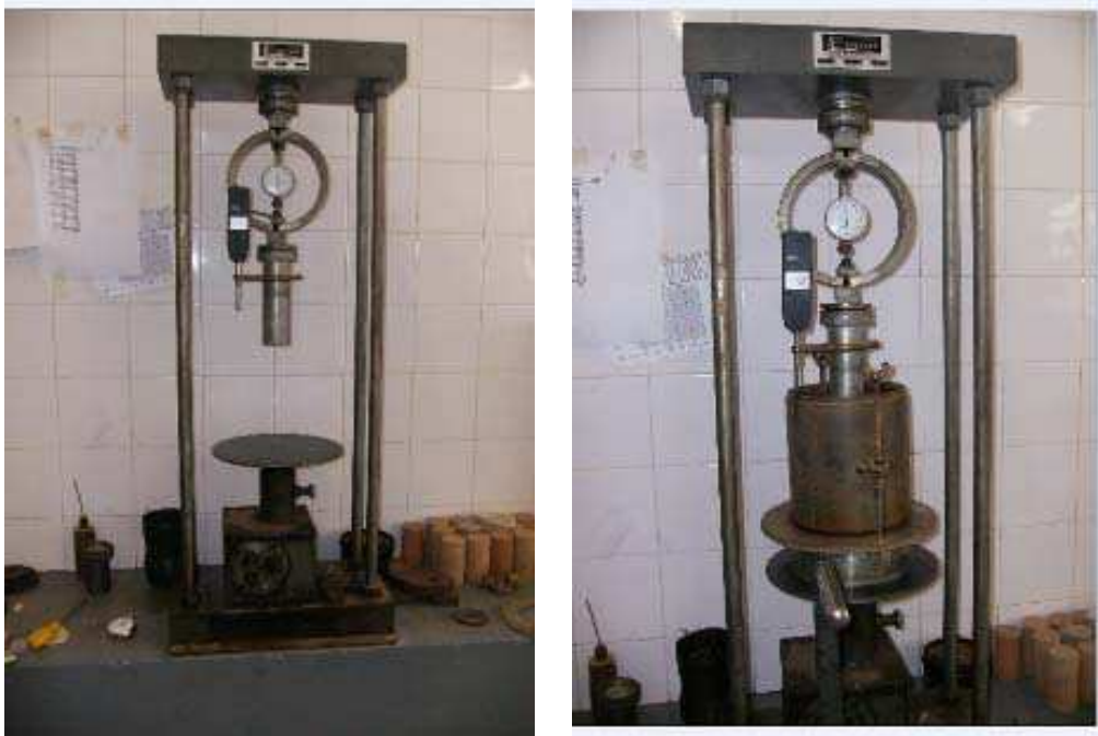
Figura 3. 26 – Prensa mecânica manual, utilizada para rompimento de CPs de ISC.
