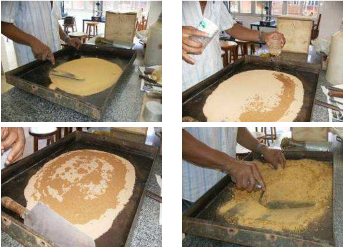
Figura 3. 13 – Etapas de uma dosagem solo-emulsão: aplicação da água de dispersão ao solo com posterior homogeneização.
