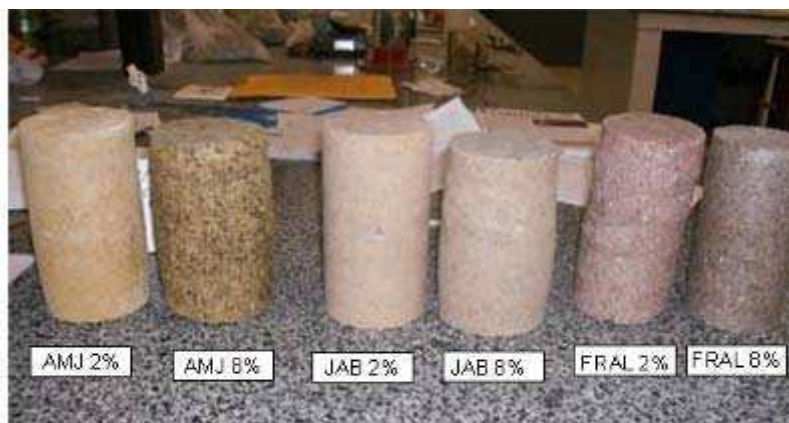
Figura 4.36 – Aspectos dos CPs depois dos ensaios de MR: AMJ, JAB e FRAL, com 2% e 8%.
