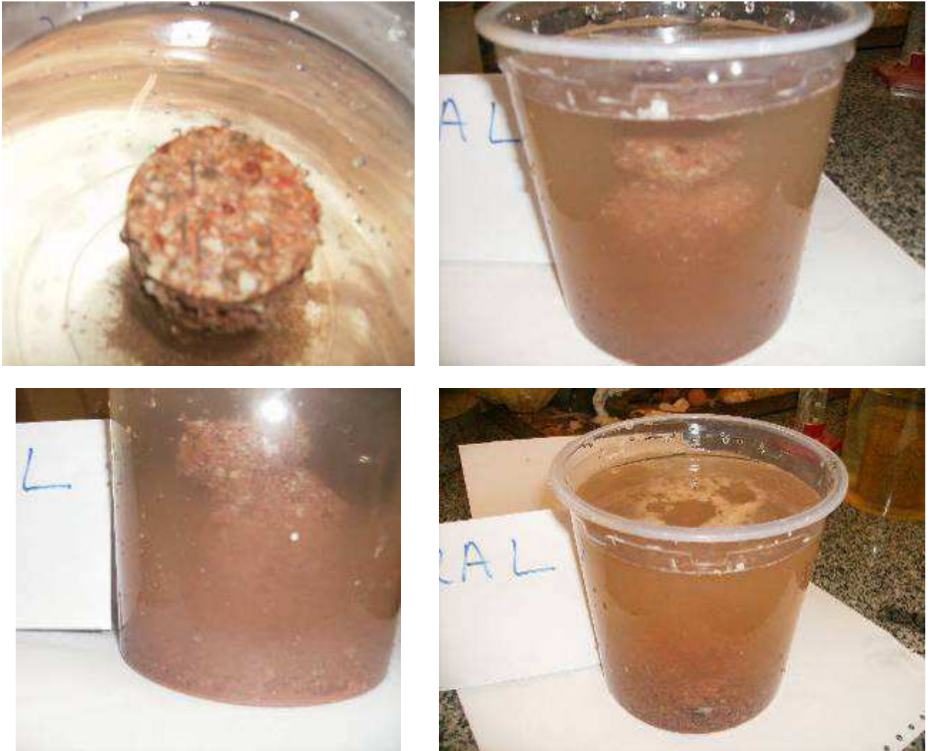
Figura 4.17 – Aspectos de CPs do solo FRAL (amostra de solo puro) desintegrados.
