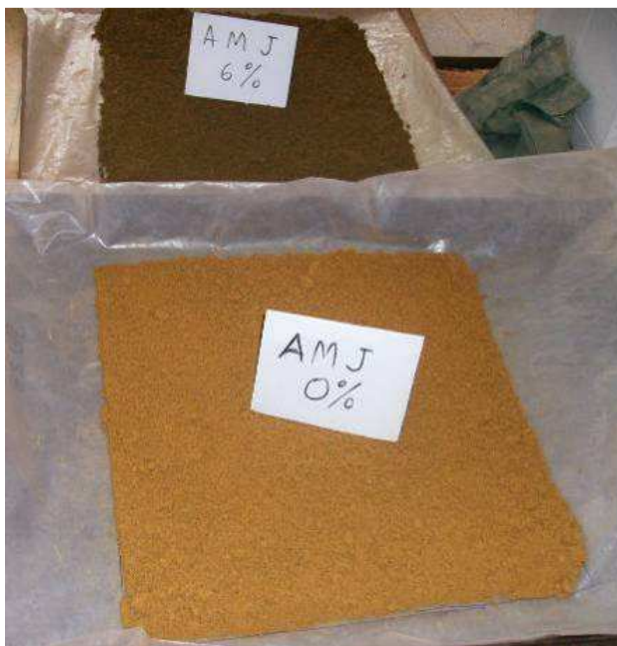
Figura 3. 16 – Amostra submetida ao procedimento de aeração e aspecto da diferença de cor conferida ao solo (já úmido) pela emulsão (solo AMJ).
