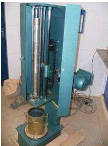
Figura 3. 17 – Compactador eletromecânico utilizado na compactação e ISC.
