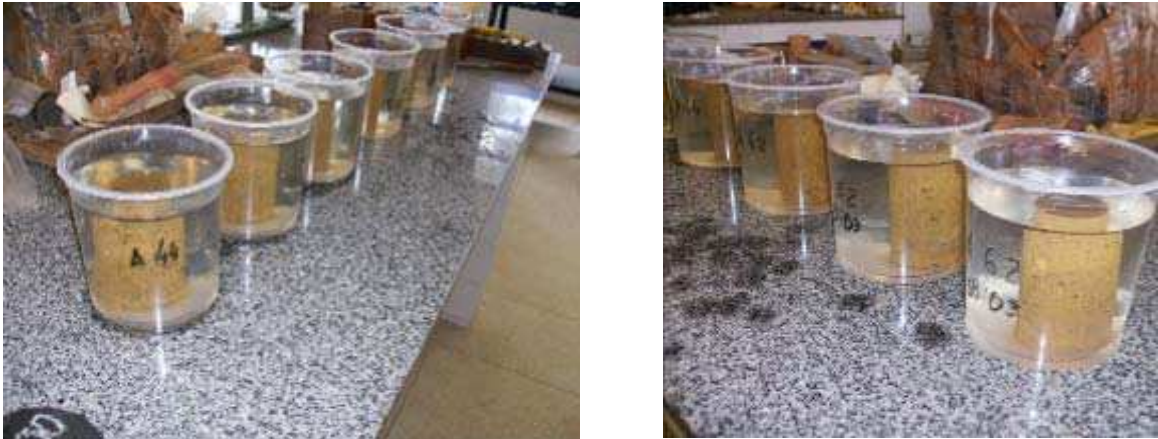
Figura 3. 21 – CPs para ensaios de RCS colocados em submersão antes do rompimento.
