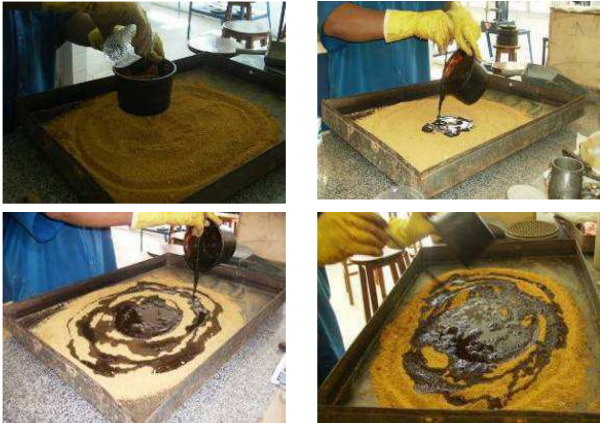
Figura 3. 14 – Aplicação da emulsão diluída ao solo.
