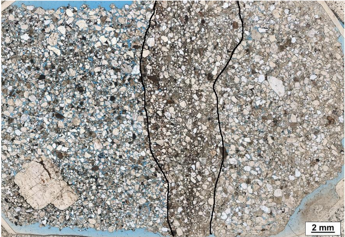
Anexo 6: Banda de deformação com intensa catáclase (cominuição e rearranjo de grãos) e consequentemente preenchimento dos poros.
