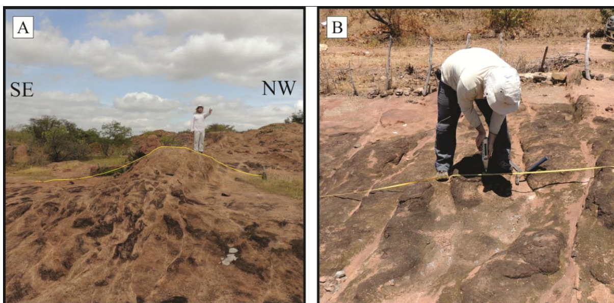
Figura 3.3: Metodologias aplicadas. (A) Perfil geomecânico iniciado em zona de single , atravessando um cluster marcado pela maior resistência ao intemperismo e conseqüentemente relevo positivo (B) Medição do valor de rebote do Martelo de Schmidt.
