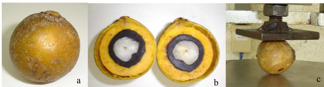
Figura 1. Aspectos do fruto da macaúba. a) Fruto inteiro; b) corte longitudinal mostrando a casca, polpa, endocarpo e amêndoa; c) ensaio de compressão entre pratos planos e paralelos.
