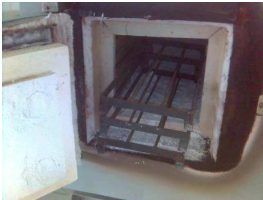
Figura 4.13 – Forno com grades para acomodação dos corpos de provas ensaiados durante a secagem
