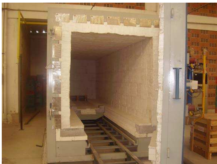
Figura 2.9 – Forno multi-combustível da Empresa Cotebras (Campina Grande-PB)
