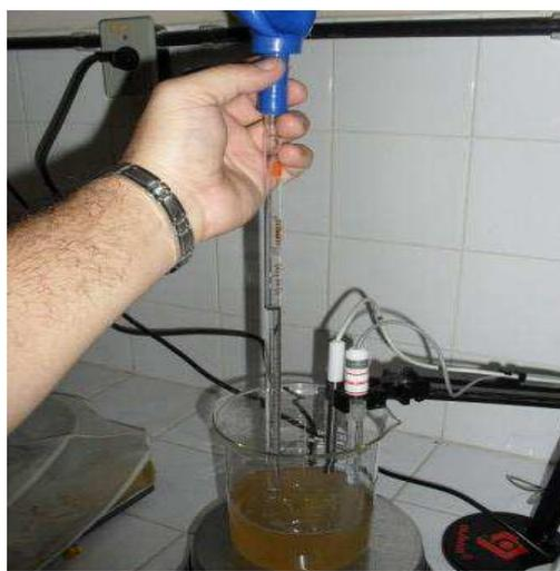
**Figura 9** – Ajuste do pH para 4.9 com adição de uma solução de hidróxido de sódio 1M sob agitação magnética.
