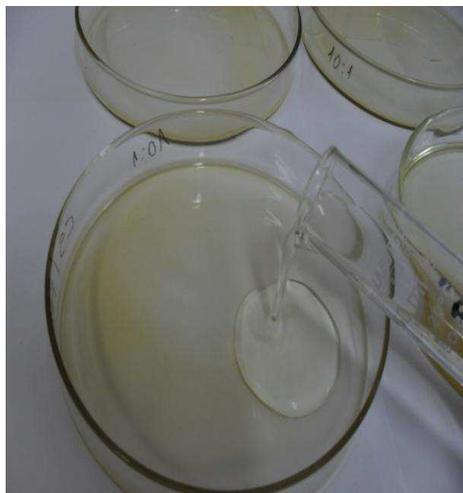
**Figura 14** – Os filmes obtidos foram cobertos com uma solução de hidróxido de sódio a 1M por 2h para assegurar a neutralização dos resíduos de ácido.
