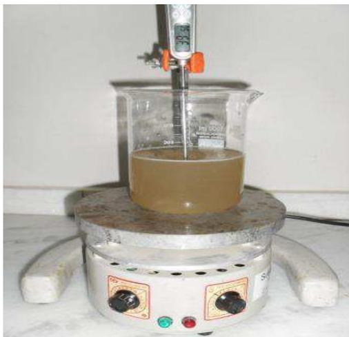
**Figura 6** – Preparação da Solução de quitosana sob agitação magnética a 45 ° por 2 horas
