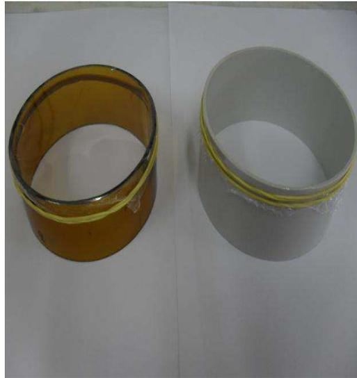
**Figura 16** – Depois do processo de lavagem os filmes são secos a temperatura ambiente em suportes adaptados.
