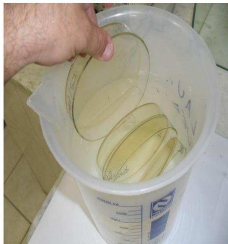
**Figura 15** – Os filmes obtidos foram cobertos com uma solução de hidróxido de sódio a 1M por 2h para assegurar a neutralização dos resíduos de ácido.
