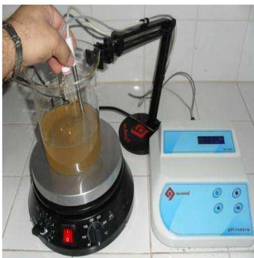
**Figura 8** – Verificação do pH da solução polimérica com o auxílio do pHmetro.
