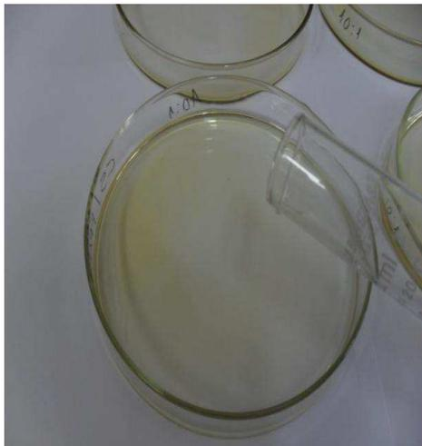
**Figura 12** – A solução quitosana/argila foi vertida em placas petri e acondicionadas em estufa a 50 °C, por aproximadamente 20h. para a formação dos filmes.
