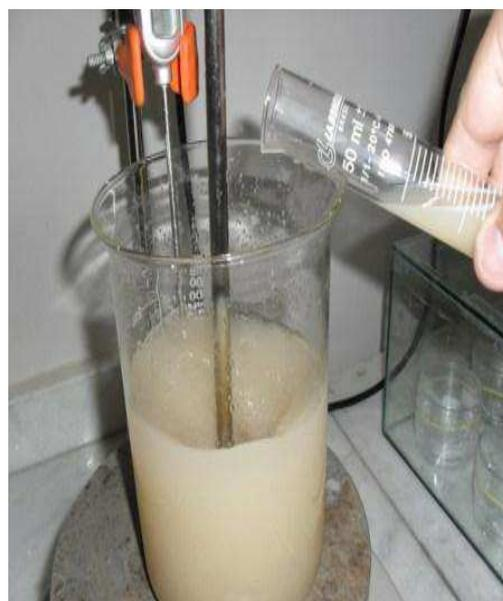
**Figura 11** – Adição da dispersão argila/água à solução de quitosana usando razões de quitosana/bentonita equivalentes a 5:1 e 10:1 e mantidas sob agitação mecânica a 60°C por 4h.
