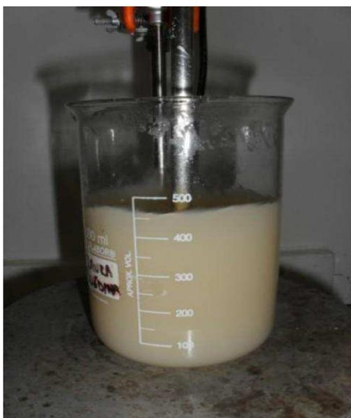
**Figura 10** – Preparação da dispersão bentonita/água destilada na concentração de 1% (m/v) sob agitação mecânica de 3000 rpm a 60°C por 5 min.
