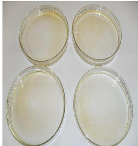
**Figura 13** – As placas contendo a solução quitosana/argila foram e acondicionadas em estufa a 50 °C, por aproximadamente 20h. para a formação dos filmes.
