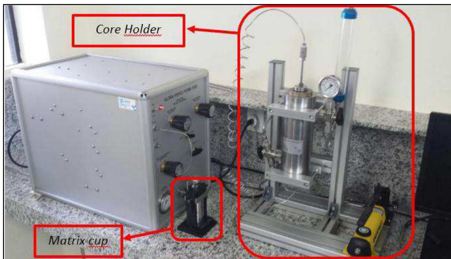
Figura 22: Ultra-Poro/Perm 500 , da Corelab , acoplado às células matrix cup e core holder .
