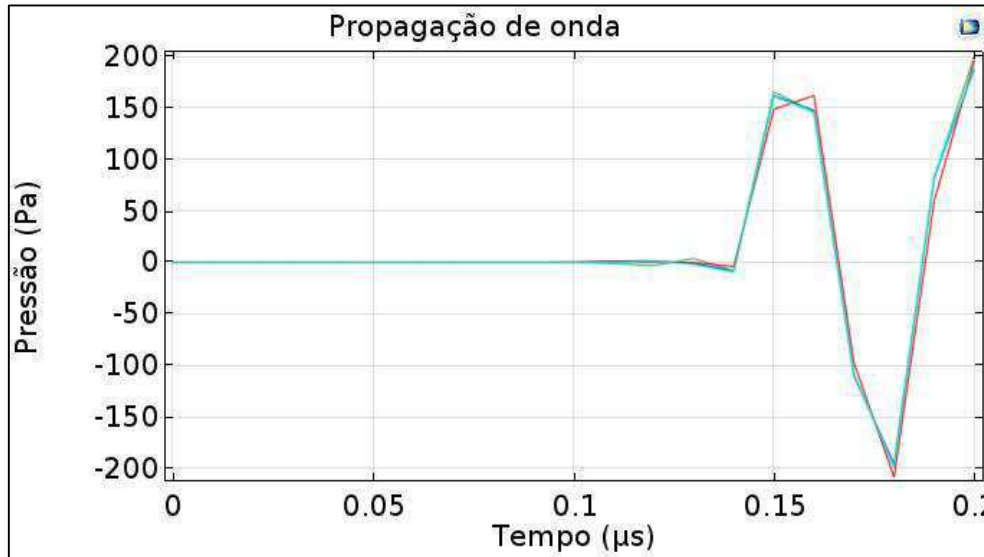
Figura 35: variação de pressão gerada pela passagem da onda simulada no COMSOL Multiphysics .
