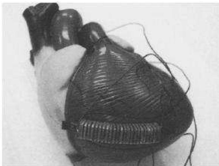
**Figura 4.3.3 – Fotografia do atuador LMF com resfriamento forçado em um modelo em tamanho real de um coração humano Fonte: (YAMBE, MARUYAMA, *et al.*, 2001)**
