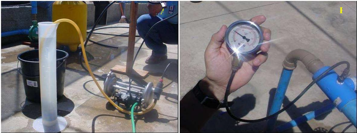
**Figura 22.** Testes na bomba injetora de fertilizantes (A) e com o manômetro (B).
