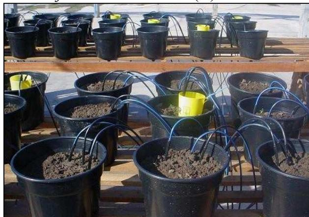
**Figura 23.** Distribuição dos coletores durante o teste de uniformidade do sistema de irrigação.
