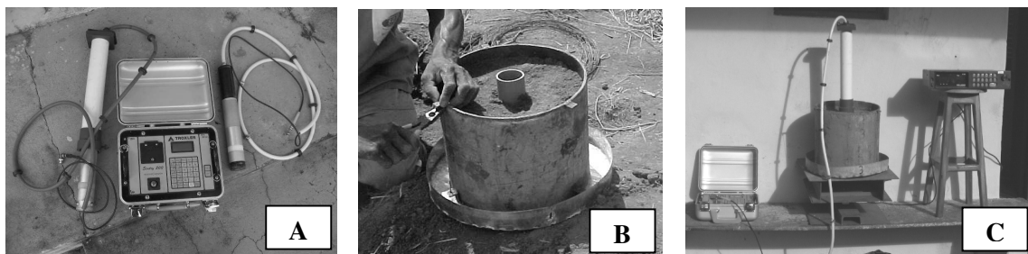
Figura 1 – Vista das sondas e unidade de controle (a), cilindro com monólito (b) e aparato experimental para leitura e pesagem dos monólitos (c).
