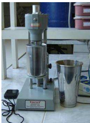
Figura 8 – Viscosímetro Fann 35A.
