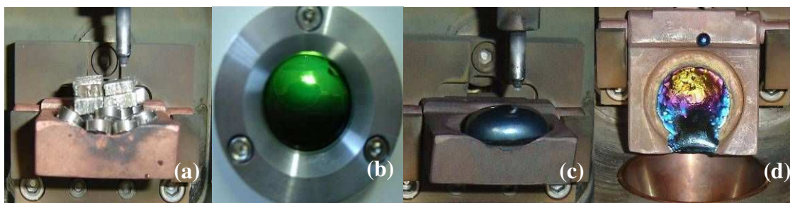
Figura 3.1 —Processo de fusão a plasma pelo método Skull Push-Pull. (a) Elementos no cadinho de cobre; (b) Tocha de plasma; (c) Botão de LMF após fusão; (d) Cadinho após a injeção. Fonte: LaMMEA, UFCG.
