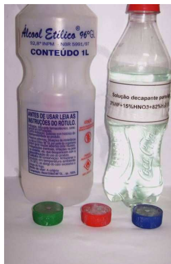
Figura 3.7- Mistura para decapagem da superfície de ligas Ni-Ti, álcool etílico e as respectivas amostras Fonte: Arquivo Próprio.
