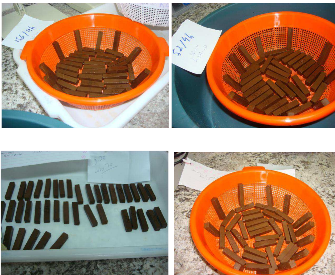
Figura 3.4 - Corpos de prova após imersão em solução alcalina e prontos para a cura em temperatura ambiente.
