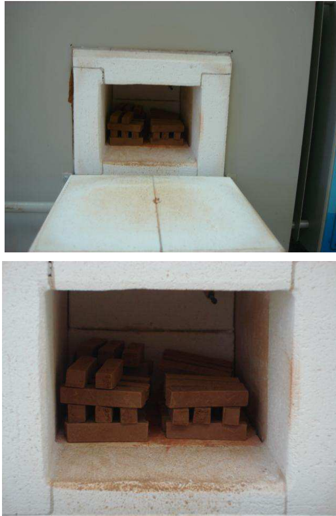
Figura 3.3 - Corpos de prova queimados a 700°C.
